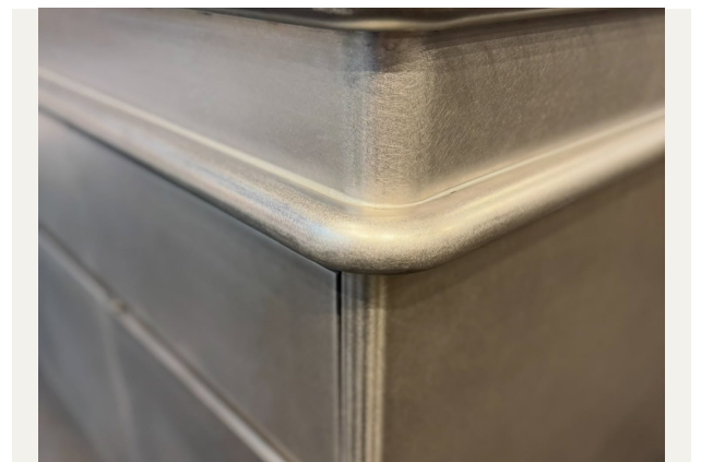
Detail van zorgvuldig afgeronde inoxhoek en lasafwerking.
