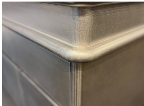
Détail d'un angle en inox soigneusement arrondi et de sa finition soudée.
